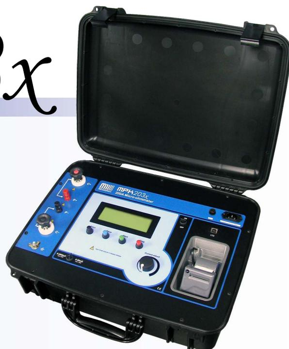
O MEGABRAS **MPK-203x** é um ohmímetro digital inteligente, portátil, controlado por microprocessador. Possui filtros e proteções otimizados para medições em subestações. Mede com alta precisão resistências muito baixas de contato de disjuntores de alta tensão, chaves seccionadoras, barramentos, etc., com correntes de teste de até 200 A. Utiliza a metodologia de Kelvin (4 terminais) para evitar erros na medição provocados pelos cabos auxiliares e as suas resistências de contato.
