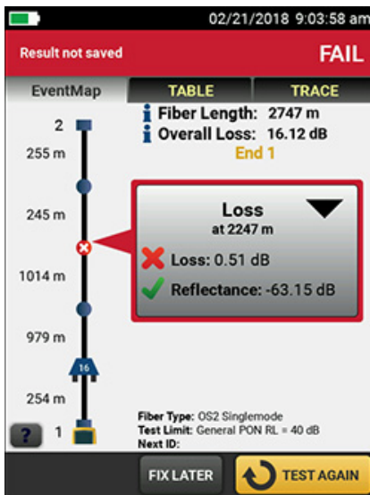
Link com um conector APC exibido como um evento de perda
