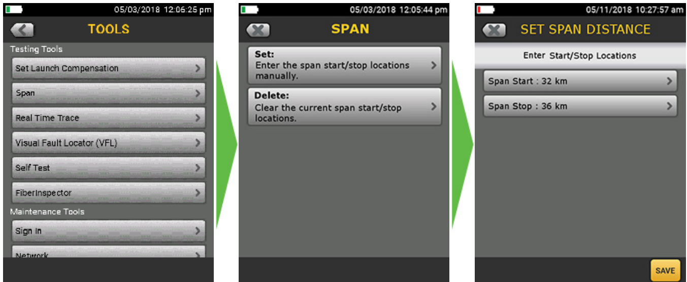
Processo para configurar Alcance em um OptiFiber Pro OTDR
